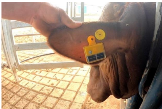
Sonkragaangedrewe GPS-oorplaatjie met sagteware op 'n plaas in Afrika
